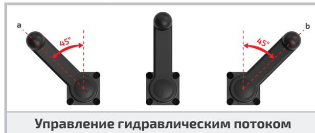
Управление гидравлическим потоком
